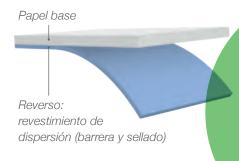
innecesarios los revestimientos o laminados especiales adicionales. El papel se puede reciclar completamente a través de los residuos de papel.
